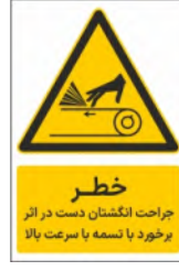
34811-Fa خطر جرات انگشتان دست در اثر برخورد با تسمه با سرعت بالا
